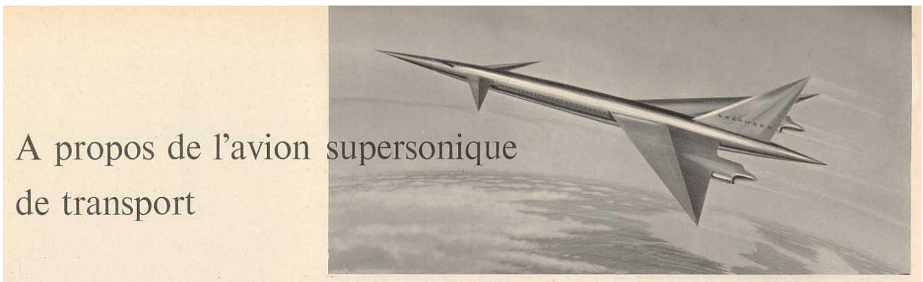
Figure 1. Le projet Lockheed d'un quadriréacteur de transport supersonique pour 80-90 passagers L'appareil répond à la formule canard
