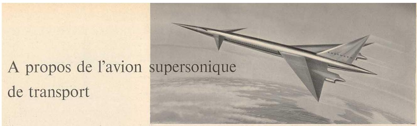
**Figure 1.** Le projet Lockheed d'un quadriréacteur de transport supersonique pour 80-90 passagers
