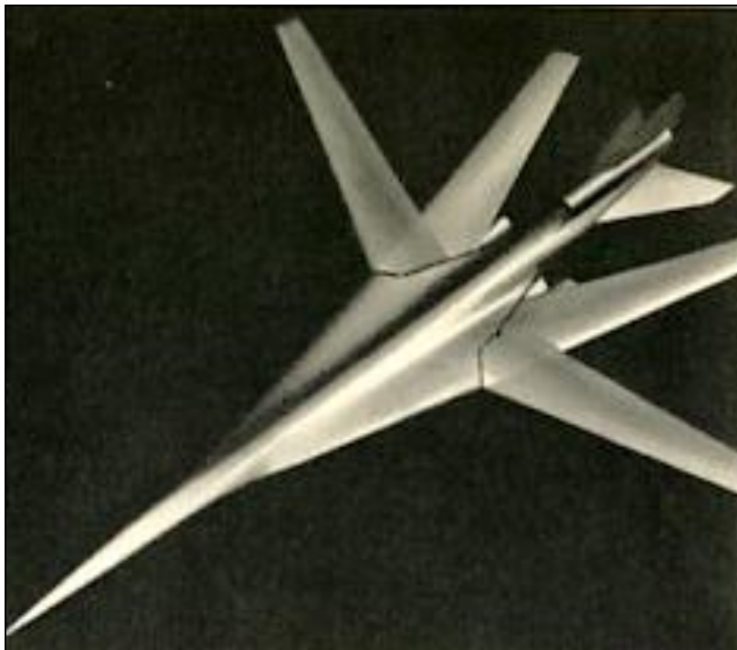
Maquette d'un courrier supersonique doté d'une voilure à géométrie variable
